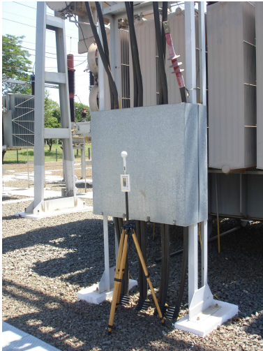
Fig. 8 – Local Típico em que o Limite de Exposição ao Campo Magnético é Superado
