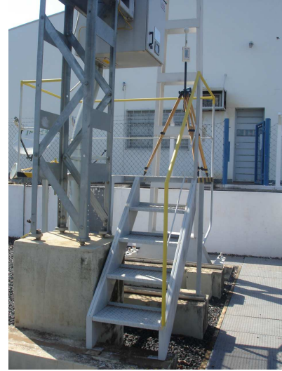
Fig. 10 – Local em que o campo elétrico tem o limite de exposição ocupacional extrapolado
